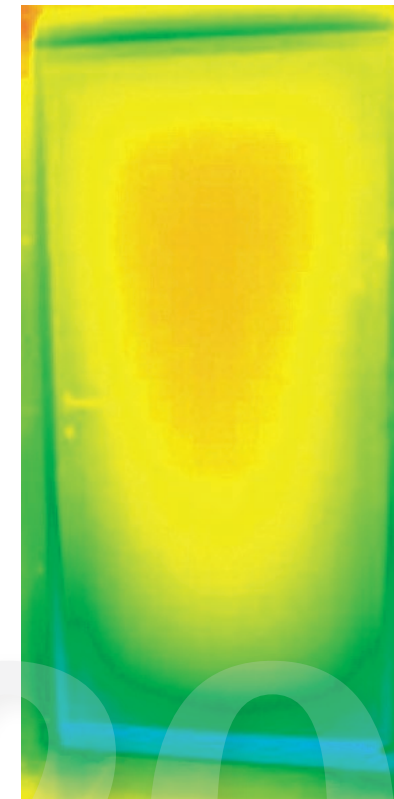
Beidseitige Aufsatzfüllung mit Vakucor Kern
