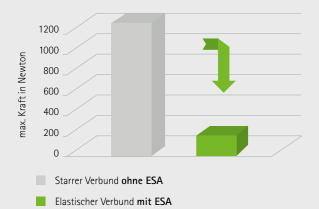
Fallbeispiel: 48 mm Sandwichelement DSA 3.0 mm / SC 43,5 mm mit und ohne ESA/DSI 1,5 mm Gemessene Kräfte in Abhängigkeit von der Temperatur (ca. 70°)
